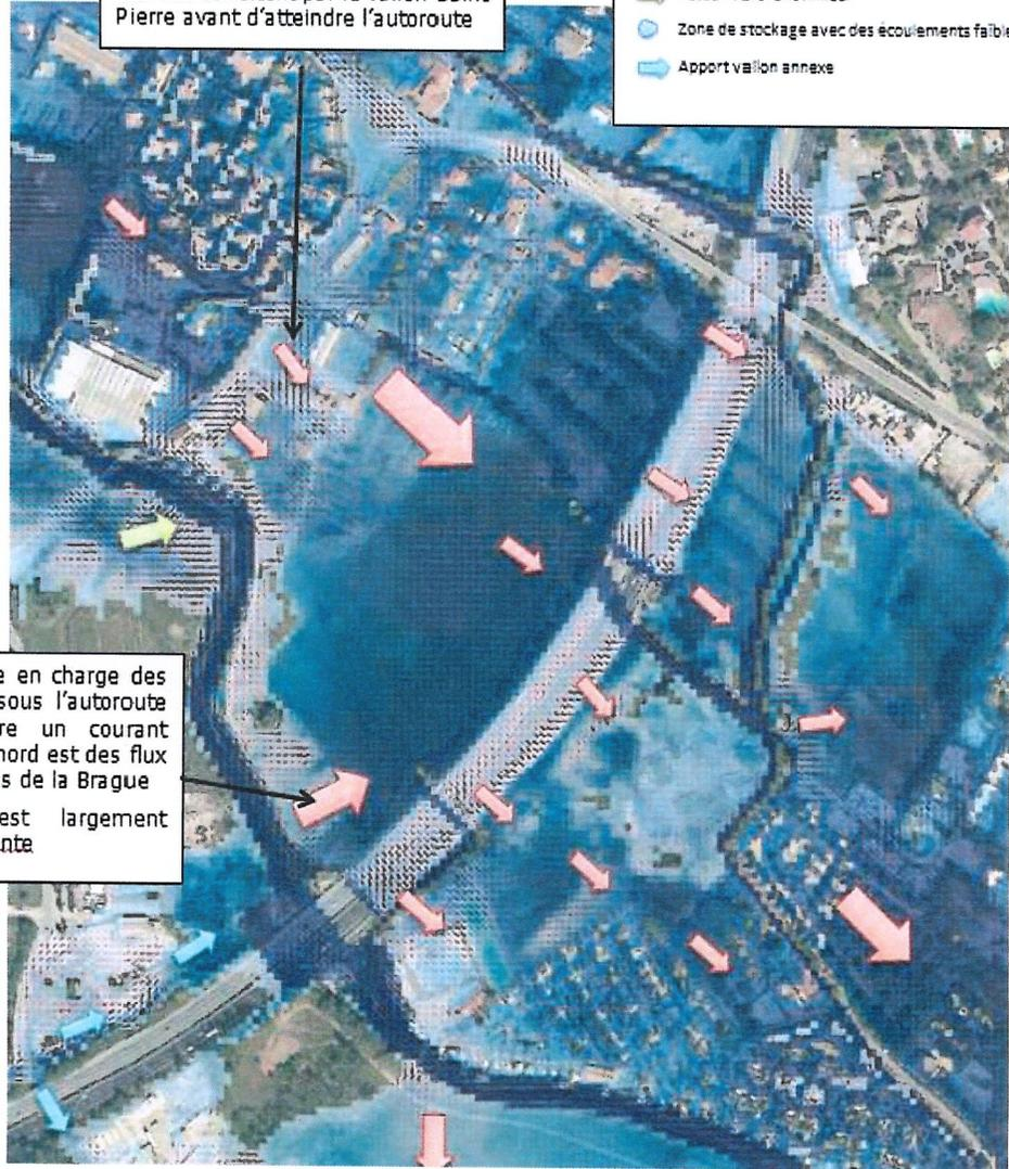
La mise en charge des buses sous l'autoroute engendre un courant vers le nord est des flux déversés de la Brague
